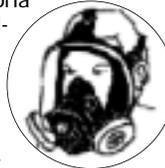
**Respirador con purificador de aire motorizado** (iniciales en inglés - PAPR) ofrecen una respiración cómoda a través de un abanico cargado con baterías el cual tira aire a través de un filtro y circula aire por todas las partes del capacete/capucha. Ellos pueden ser usados por la mayoría de los trabajadores que tienen barbas. Cartuchos/filtros deben hacer juego con los contaminantes y ser cambiados periodicamente.
