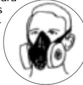
**Respirador facial de cara completa** ofrecen mas protección que el respirador a media cara. Ellos pueden ser usados para protección contra la mayoría de los vapores, gases ácidos, polvo o humo de soldaduras. La protección de la cara protege la cara y ojos de irritaciones y contaminantes. Cartuchos/filtros deben hacer juego con los contaminantes y ser cambiados periodicamente.
